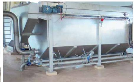
Flotación por aire disuelto "D.A.F"
