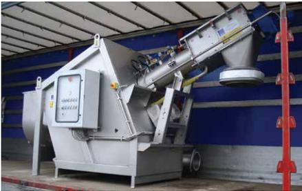
Planta de pretratamiento receptora de camiones atmosféricos
